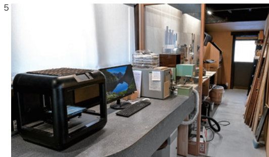
池田晃将のアトリエ 真ん中の緑色の機械は0.2mm程の微細な螺鈿チップを切り出せるパルスレーザー。
